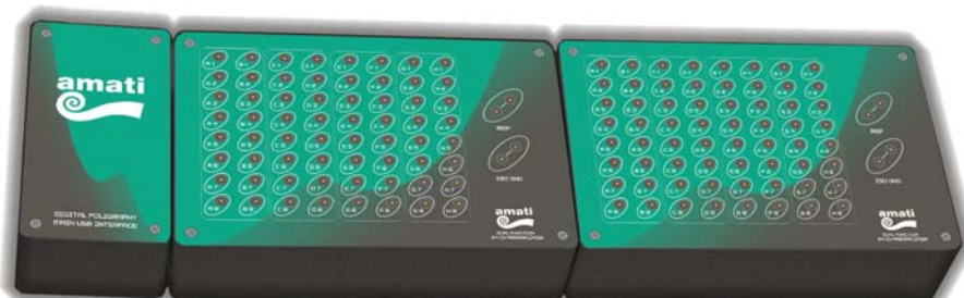
EEG 128 canales - 64 canales + 64 canales.
