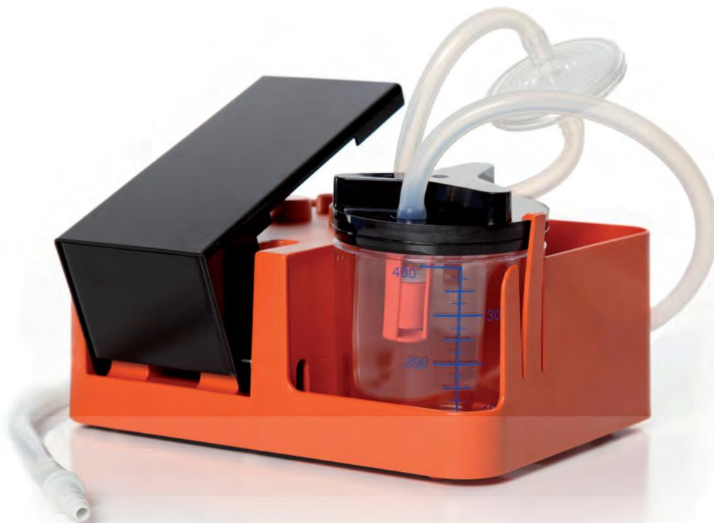
NEW EMIVAC es una unidad de succión portátil que funciona sin electricidad sino con pedal. No necesita lubricación ni cambio de batería y siempre está listo para ser usado. Puede ser usado para aspiraciones suaves, tales como aspiraciones traqueales en niños pequeños. El vacío máximo es de 300 mmHg. Equipado con un vaso de policarbonato de 400 ml con válvula de desagüe.
